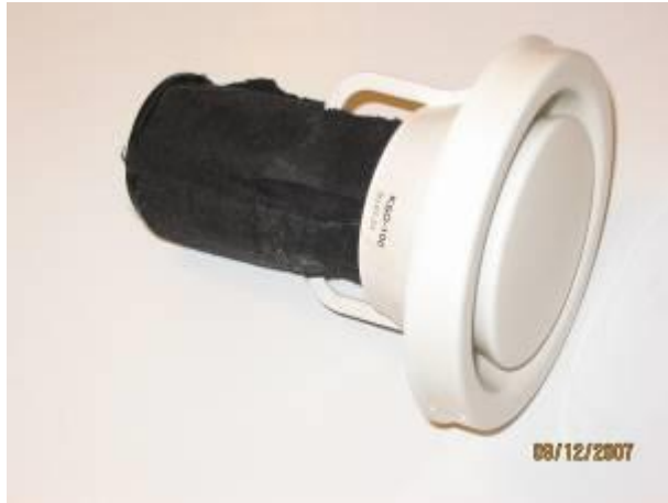
Kuva 2. Puhdista venttiili ja sylinteri harjalla tai imuroimalla. Mineraalivillaisen äänenvaimennussylinterin kastumista tulisi välttää. Kiinnitä vaahtomuovitiiviste.
